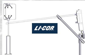
Per calcolare il flusso di  $\text{CO}_2$  è necessario accoppiare il LICOR ad un anemometro sonico. L'insieme di anemometro e analizzatore di gas costituisce un sistema di **eddy covariance**.
